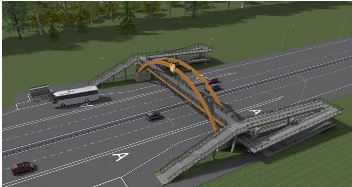
Пешеходный переход открытого типа, пролетное строение выполнено в виде арки из клееной древесины с ходьбой посередине. Полная длина пролета  $L=36,8$  м.
